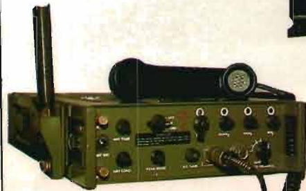
COLLINS - Amplificatore 5482-4A, in/out. 28 DC - 2700 W, 2-30 MHz sintonia automatica, power supply 426-U2, accordatore antenna automatico, della serie: 490T-9, 490T-1, 180L (-).
