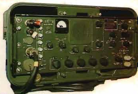
NATIONAL R1490 - Ricevitore 2-30 MHz stato solido, completo di filtro, notch, rete, 110 E 24 DC.
