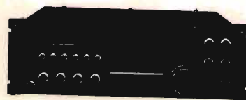
ICOM IC 781 ricetrasmittitore multimodo HF, 150 W pep
