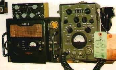
COLLINS - Amplificatore 5482-4A, in/out. 28 DC - 2700 W, 2-30 MHz sintonia automatica, power supply 426-U2, accordatore antenna automatico, della serie: 490T-9, 490T-1, 180L (-).
